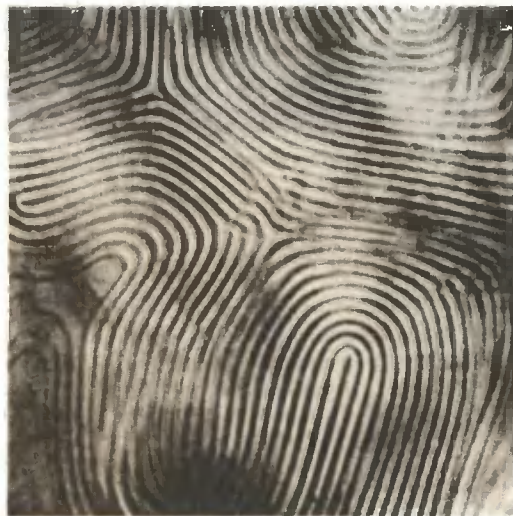
Раствор полипептида поли- \gamma -бензил-L-глутамата в органическом растворителе диоксане образует холестерическую структуру.
